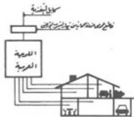
حماية كمال الجين من تيار التسرب الارضى MAINS PROTECTION
